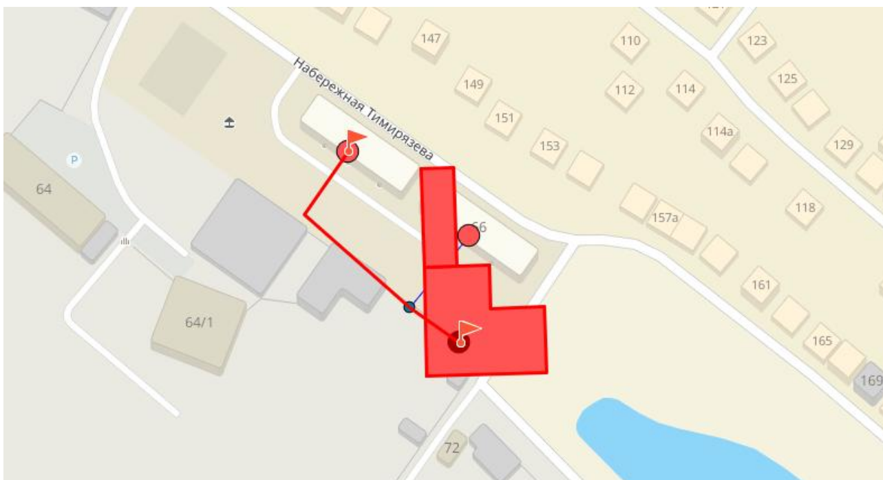
Рисунок 3.27 – Трассировка теплопровода от котельной Т-13 до конечного потребителя «Набережная Тимирязева, 68»
